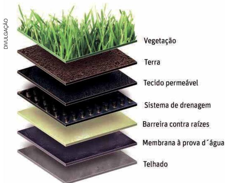
*Podendo ser feito em laje ou telha, o Telhado Verde é composto por 6 camadas, que garantem a integridade do telhado*
