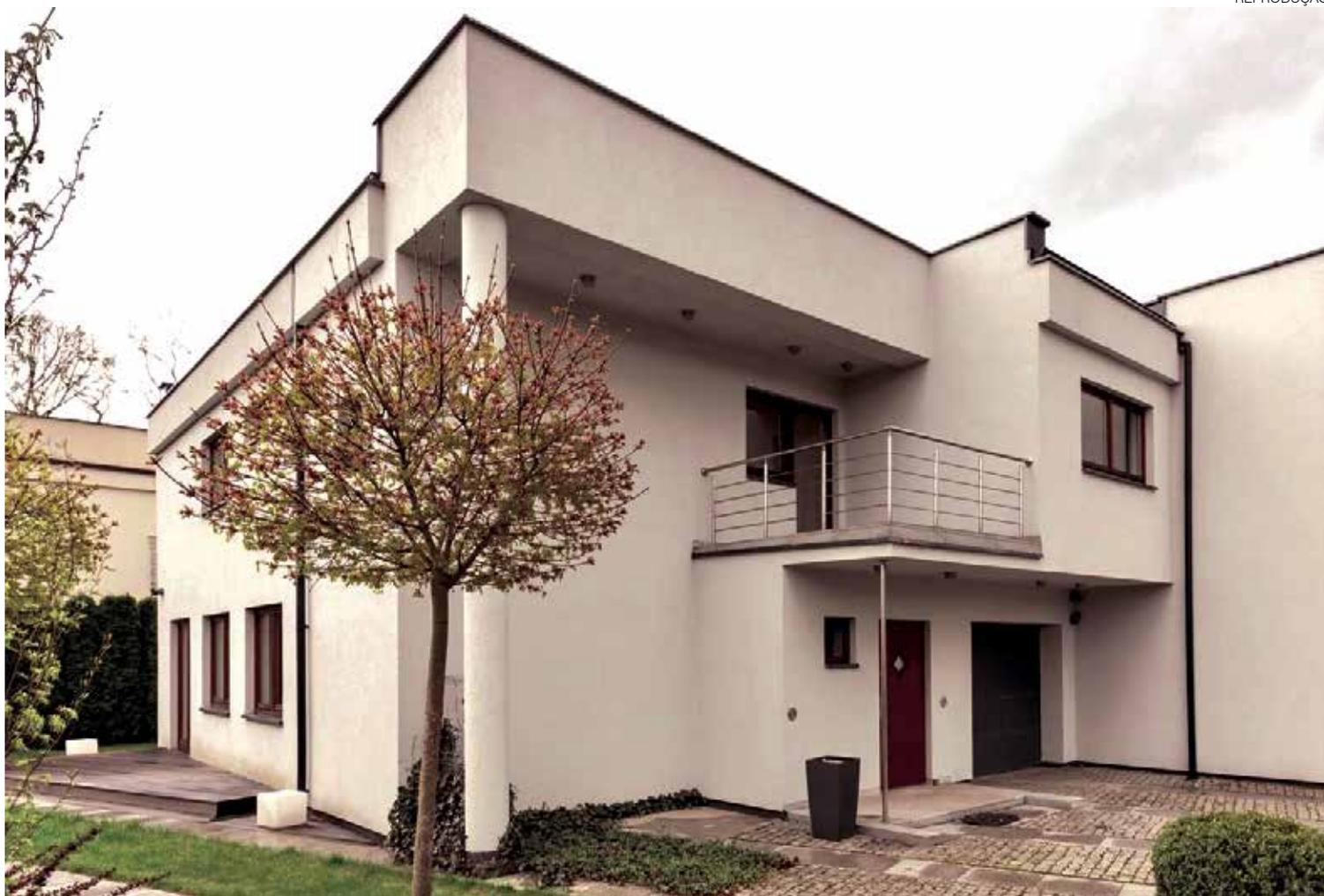
*A platibanda é um tipo de cobertura responsável por esconder o telhado e as calhas*
