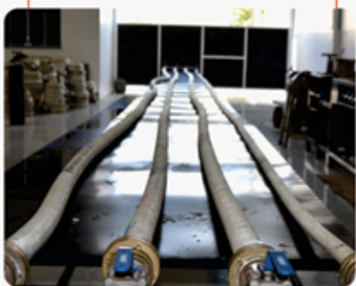
Teste Hidrostático em Mangueiras de Incêndios
