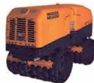
ROLO COMPACTADOR TELEGUIADO
