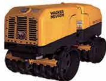
ROLO COMPACTADOR TELEGUIADO
