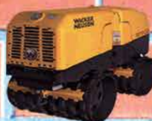
ROLO COMPACTADOR TELEGUIADO
