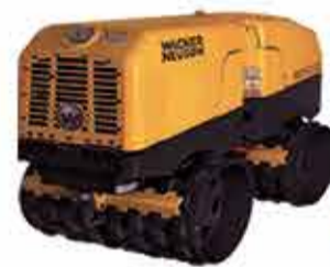
ROLO COMPACTADOR TELEGUIADO
