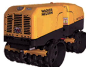
ROLO COMPACTADOR TELEGUIADO
