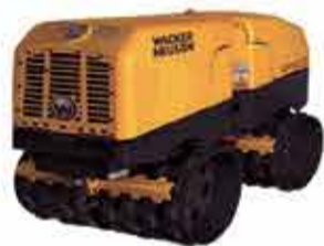
ROLO COMPACTADOR TELEGUIADO
