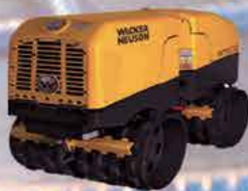
ROLO COMPACTADOR TELEGUIADO
