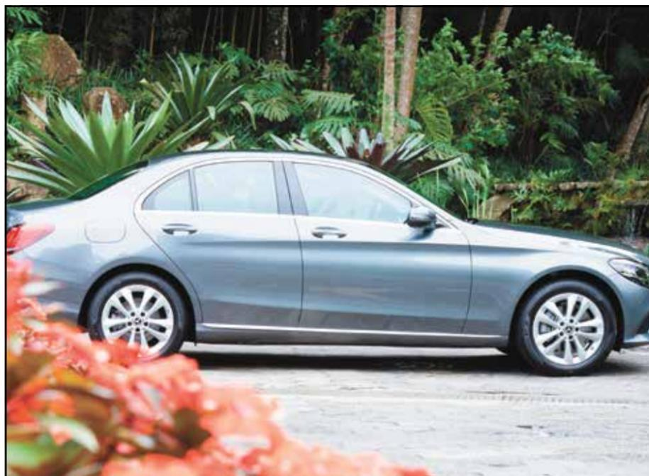
Motor: 1.5 litro, 1.497 cm<sup>3</sup>, turbo, 4 cilindros em linha, gasolina. Sistema de recuperação de energia nas frenagens / desaceleração e função coasting (roda-livre) com motor totalmente desligado. Motor elétrico de arranque/alternador unificado acionado por correia BSG (Belt-driven Starter-generator)
