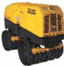
ROLO COMPACTADOR TELEGUIADO
