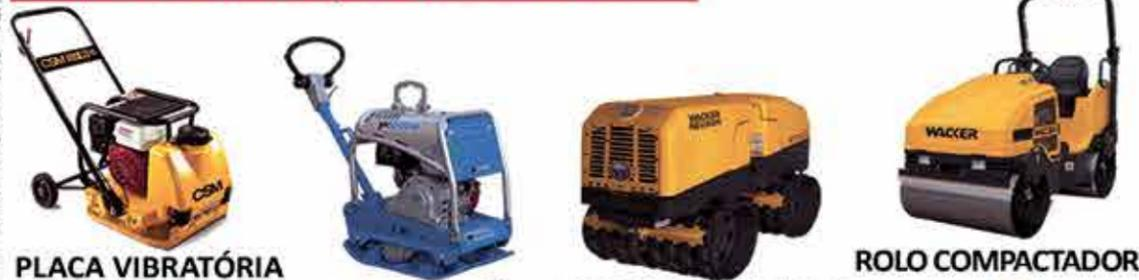
PLACA VIBRATÓRIA    PLACA VIBRATÓRIA REVERSÍVEL    ROLO COMPACTADOR TELEGUIADO    ROLO COMPACTADOR
