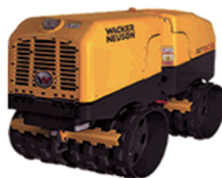
ROLO COMPACTADOR TELEGUIADO
