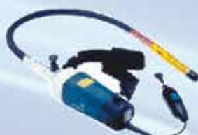
VIBRADOR PORTÁTIL P/ CONCRETO
