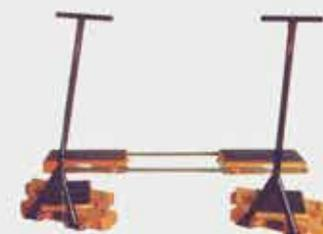
TARTARUGA HIDRÁULICA p/máquinas industriais
