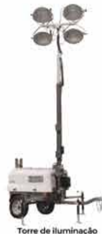
Torre de iluminação
